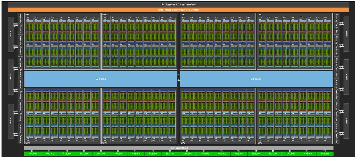
图 6. 配备 144 个 SM 的完整 GH100 GPU 核心
